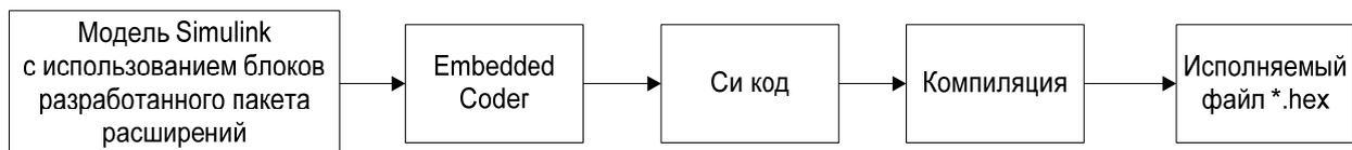
Рис. 5. Схема автоматизированной генерации кода из модели Simulink
